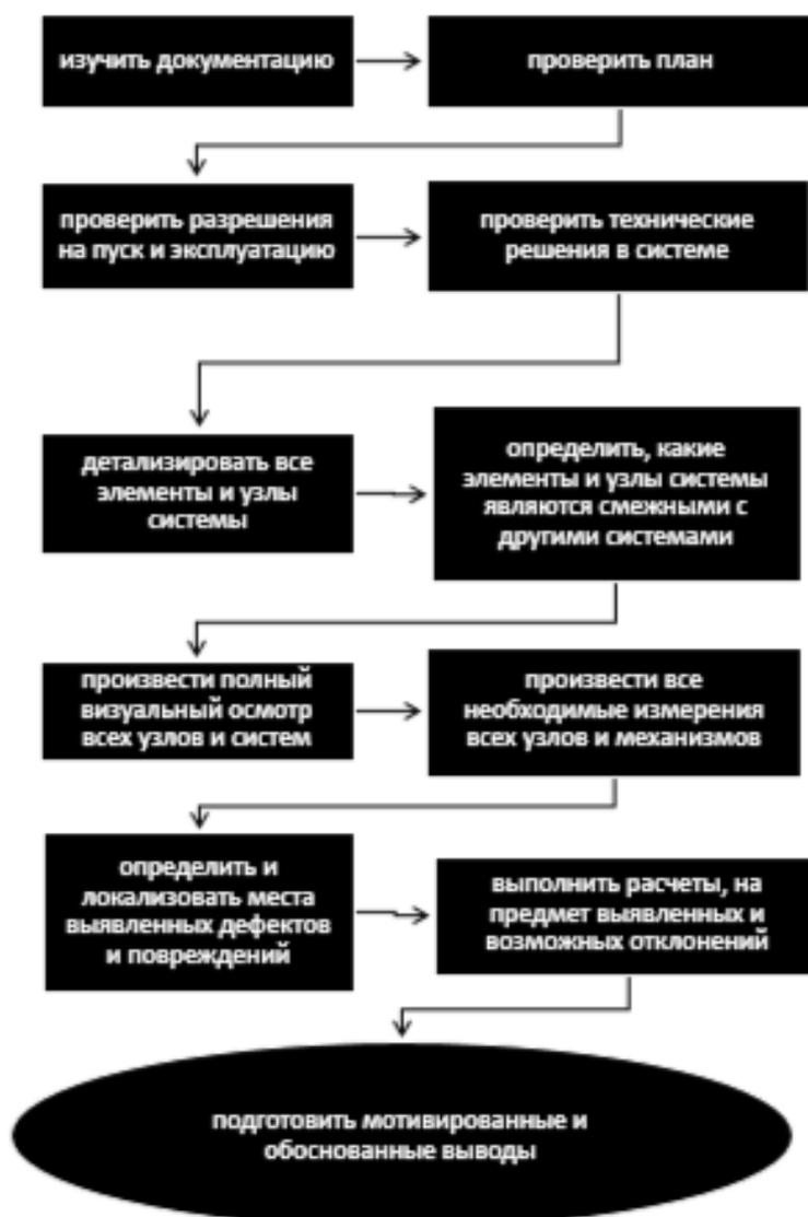
Рис. 3 Схема определение состояния инженерных систем
